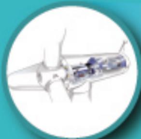
La nacelle está compuesta de un generador, una góndola y el buje.
